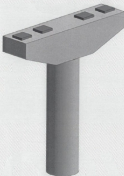
<그림 6> 교각 3D 모델링(3D Modeling of Pier)
